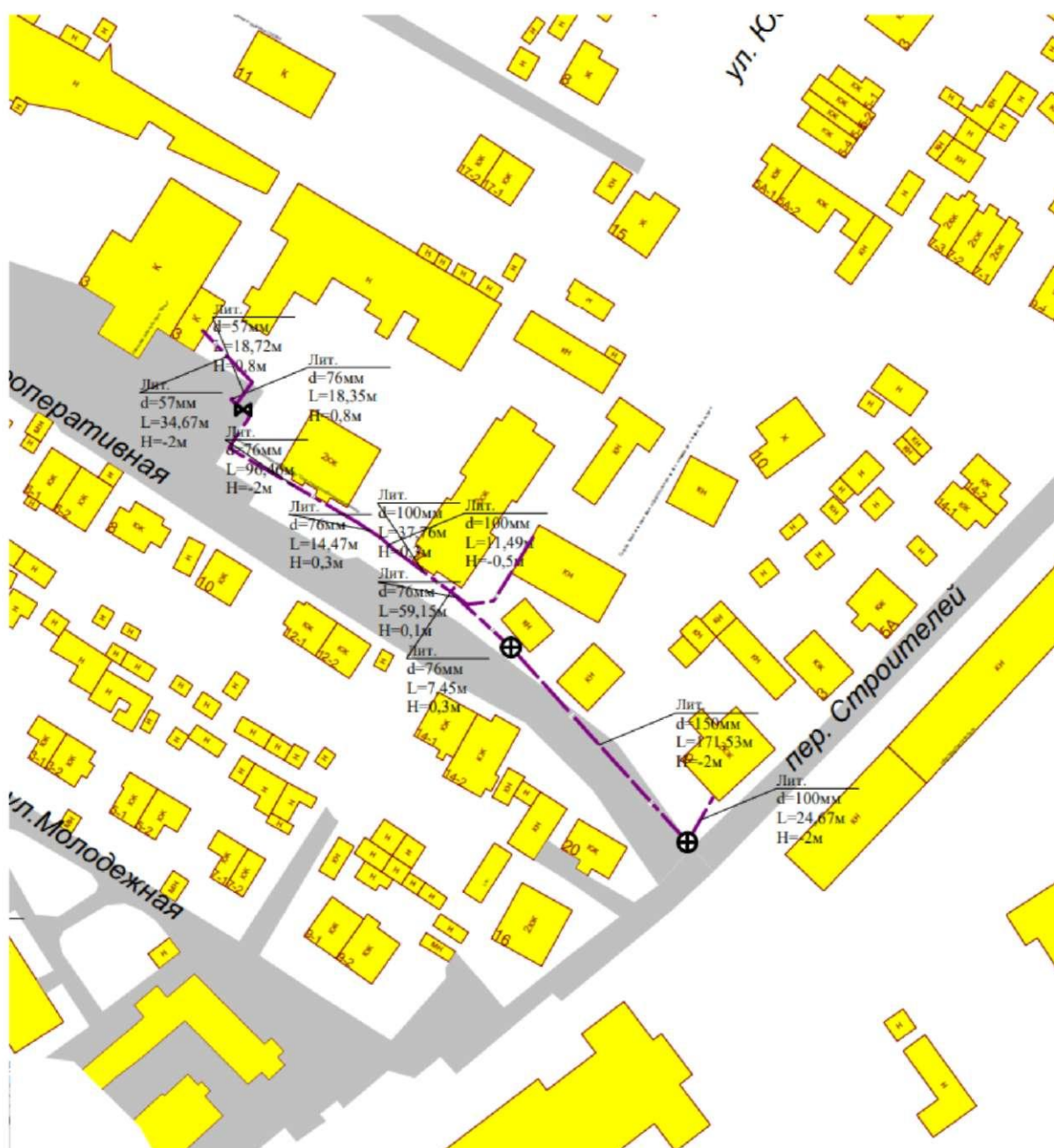
Рисунок 1.3.2.1 - Схема расположения тепловой сети котельной СДК п.
