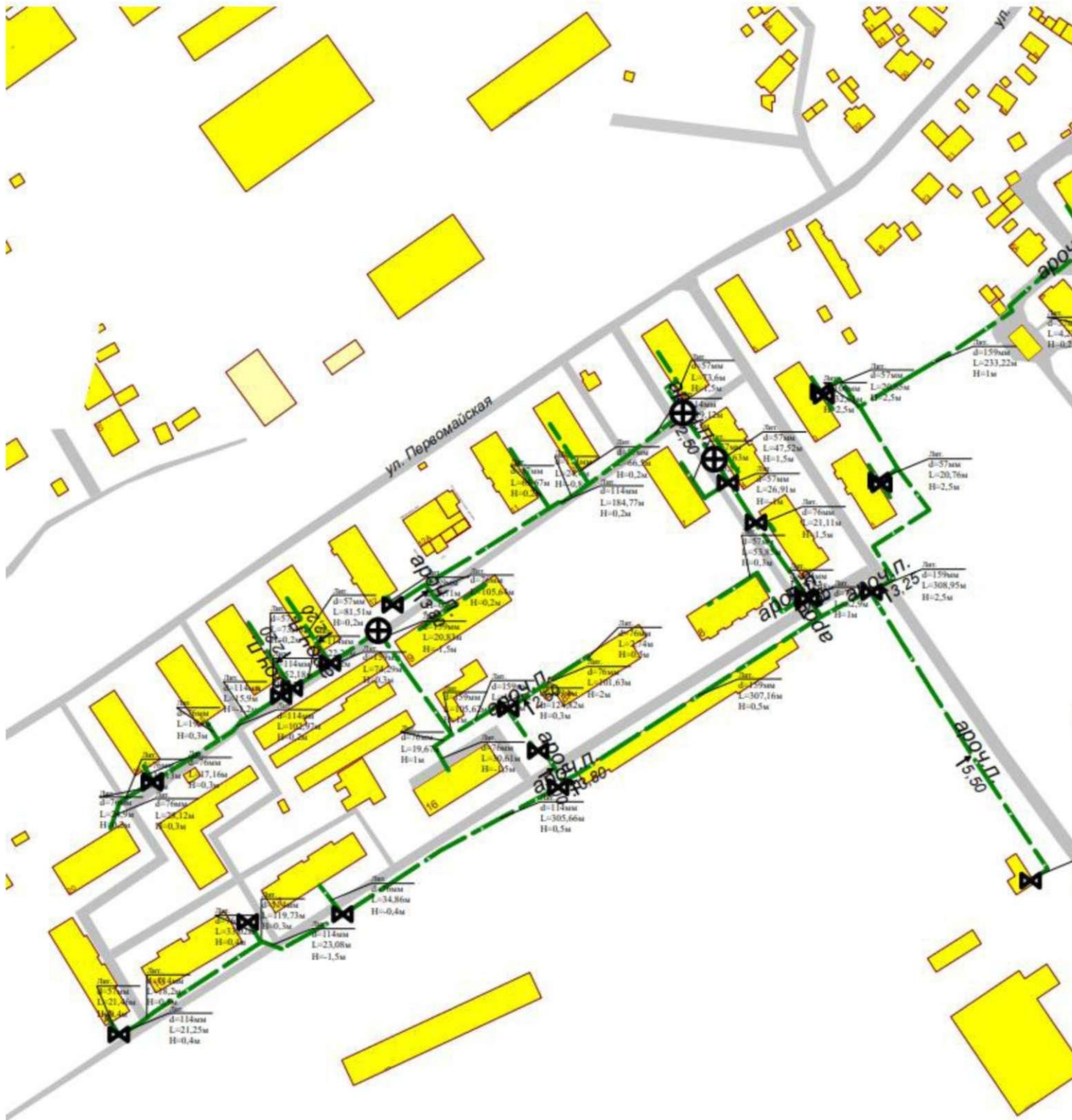
Рисунок 1.3.2.2 - Схема расположения тепловой сети котельной «Индийская» п. Сургут, ул. Первомайская
